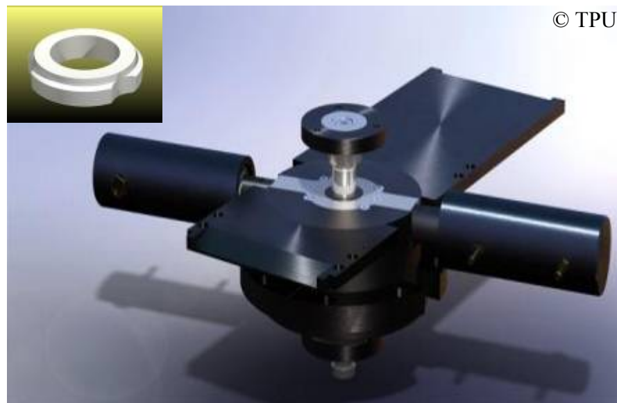
«Ультразвуковая» пресс-форма для промышленного производства кольцевых керамических изоляторов электронно- оптических преобразователей
