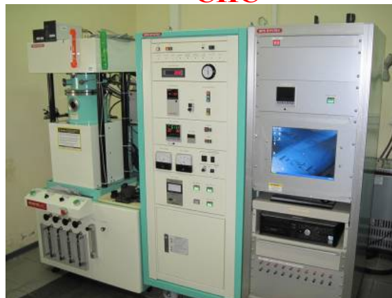
Установка СПС SPS 515S (Sumitomo)
