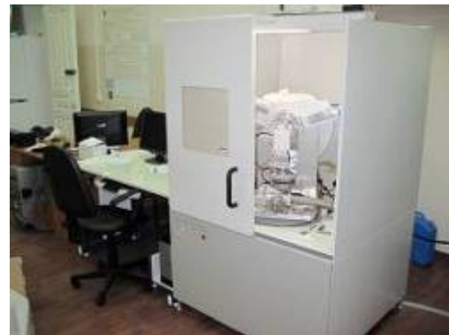
Дифрактометр XRD-7000S Shimadzu с высокотемпературной приставкой 20...2200°C
