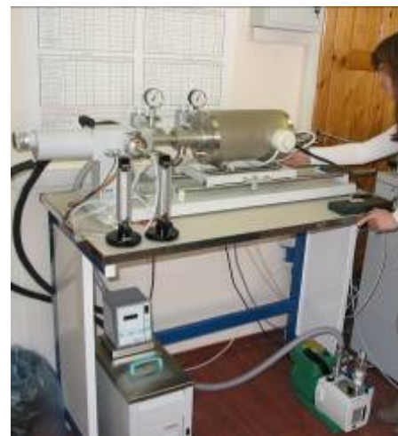
Высокотемпературный вакуумный дилатометр DIL 402 E/7 NETZSCH (2200°C)
