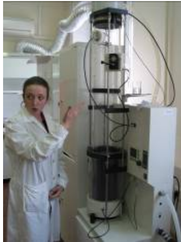
Установка синтеза НП распылением-сушкой Nano Spray Dryer B-90 Buchi
