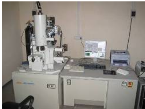
СЭМ JSM 7500F JEOL с микроанализатором EDS
